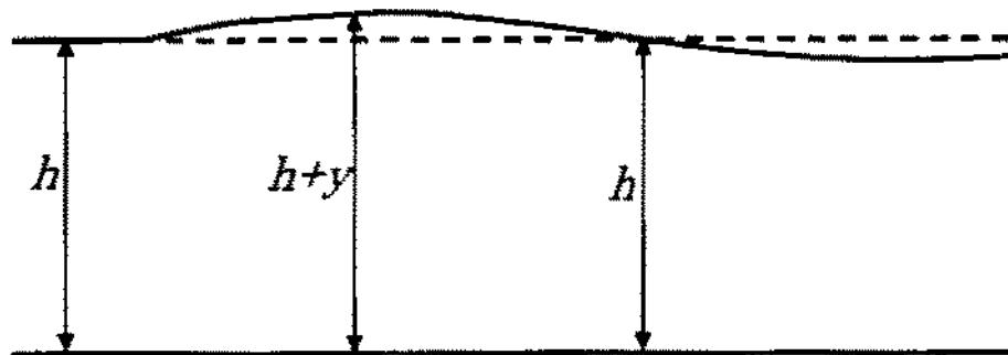
断面図(ただし水平方向に比べ鉛直方向に誇張している。波の波長は水深  $h$  よりも十分に長いと考えよ。)
