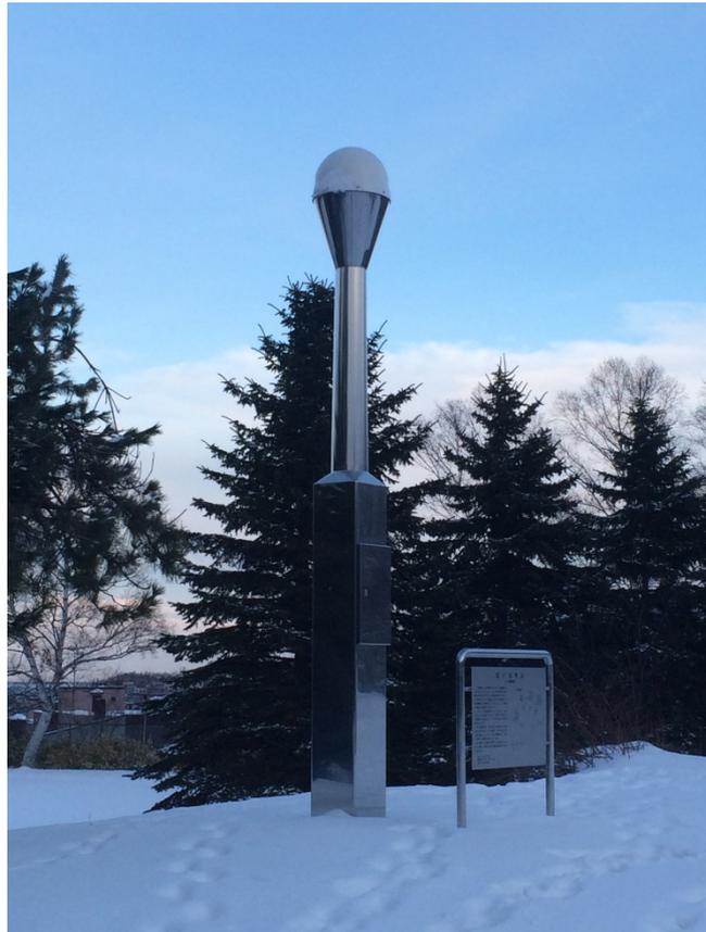
図 1-1 実際に設置されている電子基準点。これは小樽市若松町平磯公園にあり、基準点番号は 940013。このような基準点が日本国内に約 1200 箇所あり、主に地殻変動を監視している。
