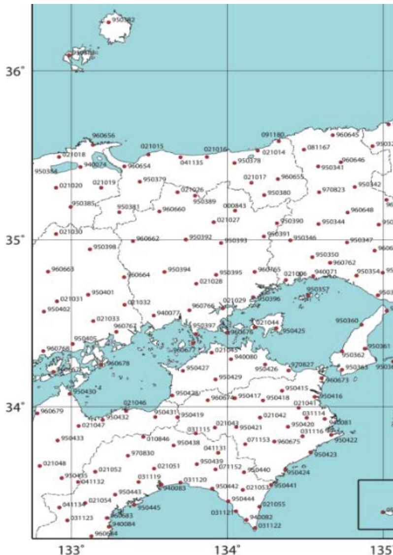
図 1.1 本研究で取り上げた観測地域(室戸から隠岐を結ぶ測線)と GEONET 電子基準点. 室戸局が 940082 であり, 隠岐島局は 950382 である.
