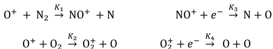
$K_*$  : 反応速度 ( $\text{m}^3/\text{s}$ )
