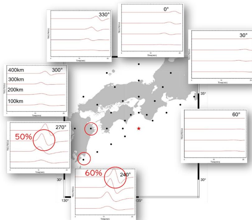
図 4.23 GPS 衛星を想定して計算した TEC 時系列。衛星視線は東に仰角 45 度で設定した。
