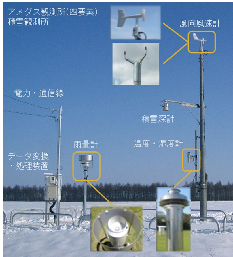
図 2.8: アメダス観測所の例 四要素（降水量、風向・風速、気温、湿度）と積雪深を観測 (気象庁: https://www.jma.go.jp/jma/kishou/know/amedas/kaisetsu.html )
