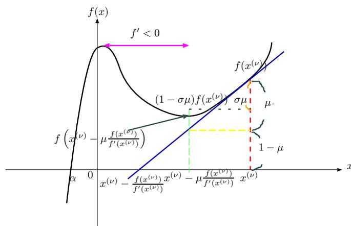
図 2: 減速ニュートン法. ピンクの領域に  $x^{(\nu+1)}$  が行かないように  $f\left(x^{(\nu)} - \mu^{(\nu)} \frac{f(x^{(\nu)})}{f'(x^{(\nu)})}\right)$  で評価して,  $f\left(x^{(\nu)} - \mu^{(\nu)} \frac{f(x^{(\nu)})}{f'(x^{(\nu)})}\right) < (1 - \sigma\mu^{(\nu)})f(x^{(\nu)})$  という制限を掛けている.
