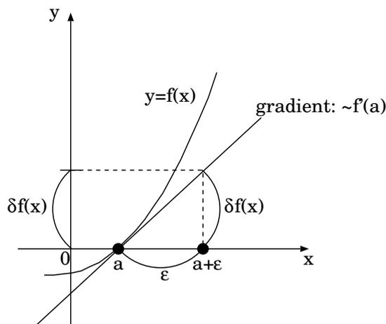
図 1: 接線近似の模式図.  $f(x)$  に  $\delta f(x)$  の誤差があったとした場合, 零点の誤差  $\epsilon$  は式 (2) で求めることができる.
