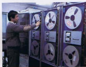
同じキューサーからの電波を、鹿島支所と同時観測するアメリカのフェアバンクスやハワイ諸島のカウアイ島でも、観測結果を磁気テープに記録する。このテープを鹿島支所まで運び、コンピューターにより相関処理する。
