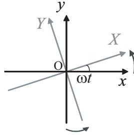
図 1. 慣性系  $(O, x, y, z)$  に対して座標系  $(O, X, Y, Z)$  は角速度  $\omega$  で回転運動している。図は  $z$  軸 ( $Z$  軸) の方向から見たもの。
