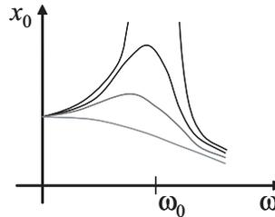
図 2. 強制振動の共鳴曲線。縦軸は振動の振幅、横軸は外力の周期。  $\omega_0$  は自由振動の周期で、外力の周期がこれに近づくと共鳴によって振幅が大きくなる。色が濃い曲線ほど抵抗が小さい場合を示す（黒は抵抗ゼロの場合で振幅は無限大に発散）。
