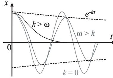
図 1. 減衰振動 ( $k < \omega$ )、減衰のない場合 ( $k = 0$ )、過減衰の場合 ( $k > \omega$ ) も併せて示す。
