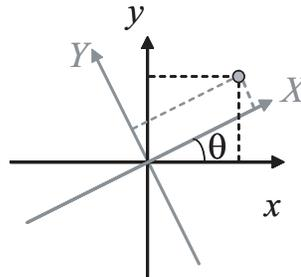
図 1. 座標の回転。点のもとの座標系での位置  $(x, y)$  と新しい座標系での位置  $(X, Y)$  は上の式のような関係になっている。
