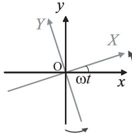
図 5. 慣性系  $(O, x, y, z)$  に対して座標系  $(O, X, Y, Z)$  は角速度  $\omega$  で回転運動している。
