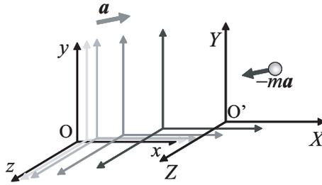
図 4. 慣性系  $(O, x, y, z)$  に対して加速度  $a$  で等加速直線運動する座標系  $(O', X, Y, Z)$  では見かけの力  $-ma$  が働く。
