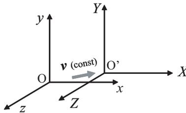
図 3. 慣性系  $(O, x, y, z)$  に対して等速直線運動する座標系  $(O', X, Y, Z)$  の間では同じ運動方程式が成り立つ。
