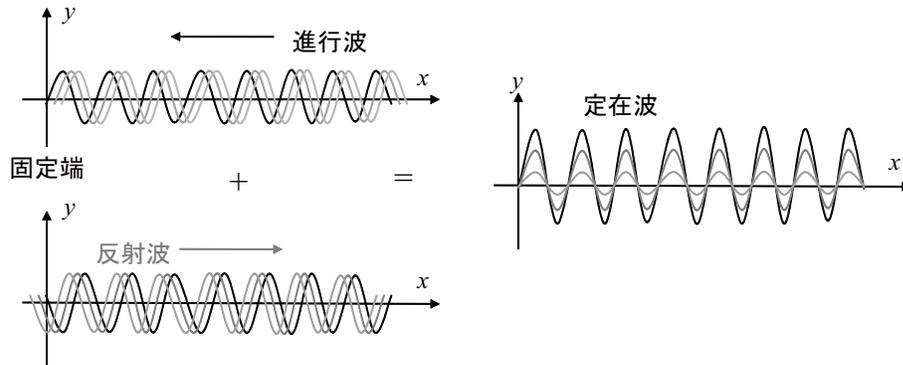
図 6. 固定端に向かって進んでゆく波（左上）とそこから反射してきた波（左下）が足しあわされた結果、伝搬せずに振幅だけが変化する定在波（右）が生じる。
