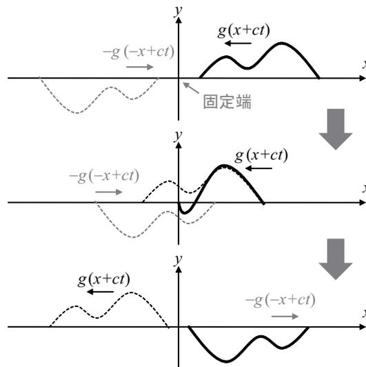
図 4. 右からやってきた波が  $x = 0$  にある固定端で反射して右に戻ってゆく様子。固定端での  $y$  の値がいつもゼロであることから、この場合の波の反射は上下と左右が逆で別々の向きに伝搬する二つの波の重ね合わせとして考えられる。
