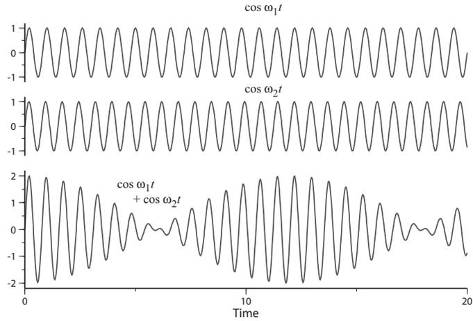
図 5. 角速度  $\omega_1$  の正弦波（上）と  $\omega_2$  の正弦波（中）を重ね合わせた合成波（下）は、 $\omega_1$  と  $\omega_2$  の中間の周波数で、両周波数の差の周波数で振幅が変わる（うなり）振動となる。
