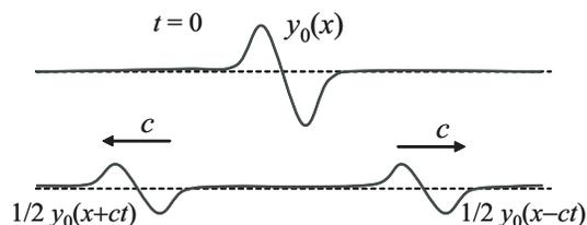
図 3. 時刻ゼロで  $y_0(x)$  の形をもった波の伝播。半分の振幅をもった同じ形の波が正と負の方向に伝播する。
