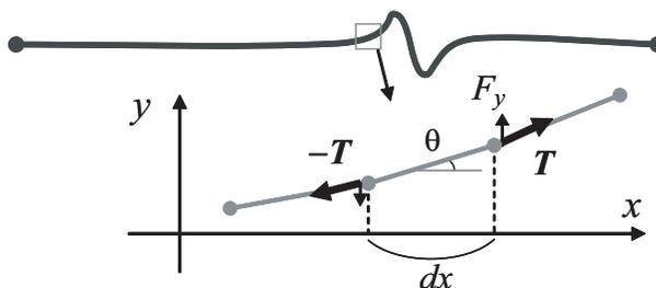
図 1. 長い弦の一部を拡大して、長さ  $dx$  の微小部分について  $y$  方向の運動を考える。
