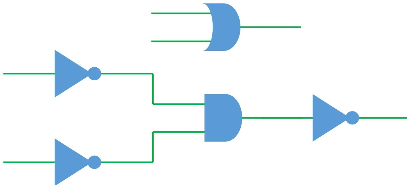
OR回路をNOT回路とAND回路で実装した例
