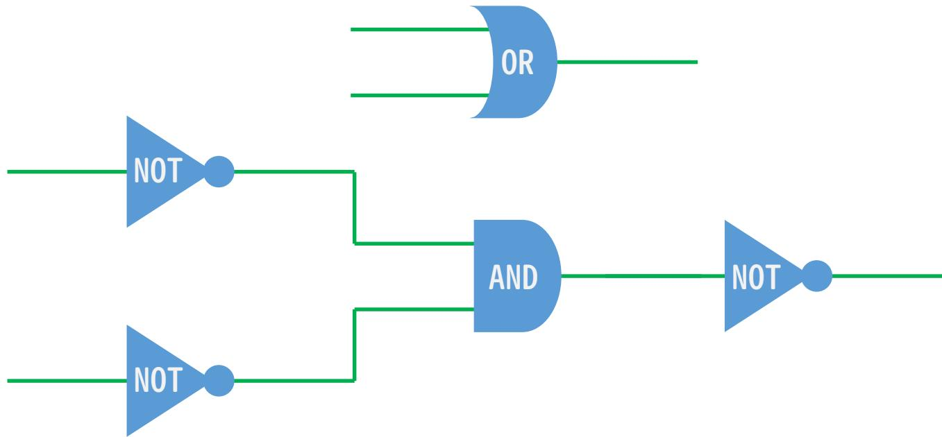
OR回路をNOT回路とAND回路で実装した例
