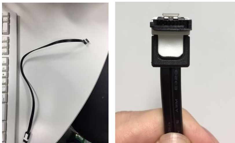
SATAケーブルとその接続部
