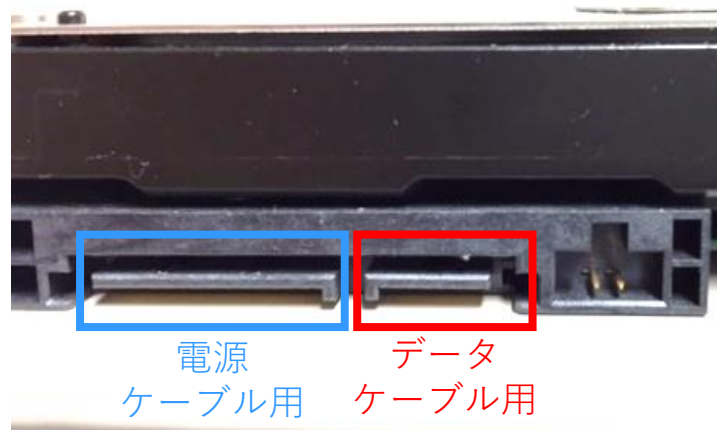
HDDのSATA接続部
