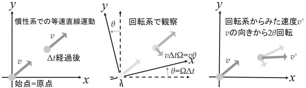
図 4.2 コリオリ力の考え方。慣性系の等速直線運動（左）は回転系から観察すると加速度を持つ（中，右）。この加速度がコリオリ力である。この例では簡単のため、質点の初期位置は回転軸を通る原点に一致させている。
