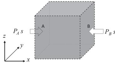
図 4.1 気圧傾度力の考え方。もし  $P_A > P_B$  なら、微小立方体には右向きの合力が働く。これが気圧傾度力である。
