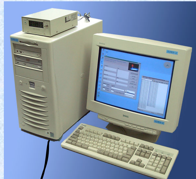
Data Recording System (400 Hzサンプリング, 16-bit A/D)
