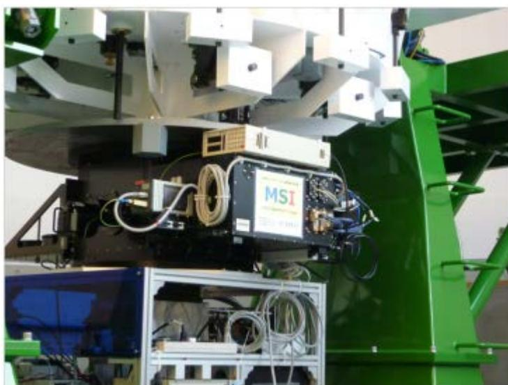
図 2.2 ピリカ望遠鏡のカセグレン焦点に取り付けられた MSI
