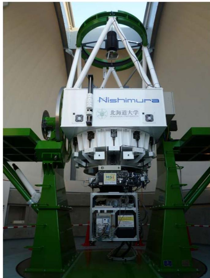
図 2.1 正面から見たピリカ望遠鏡 カセグレン焦点には望遠鏡に近い側に MSI、その後ろに近赤外エッセル分光器 NICE がついている。
