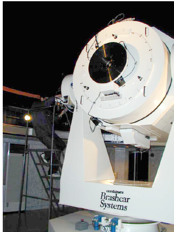
図 11: 陸別町「銀河の森 天文台」の口径 115 cm 反射望遠鏡. ナスミス焦点の架台が高いのでセッティングには脚立を用いる.
