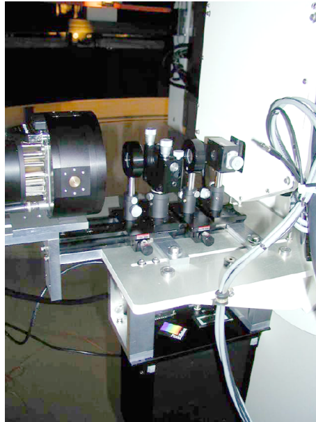
図 8: ナスミス焦点架台部. 左から CCD カメラ, レンズ, 干渉フィルター, レンズ, スリットと並んでいる.
