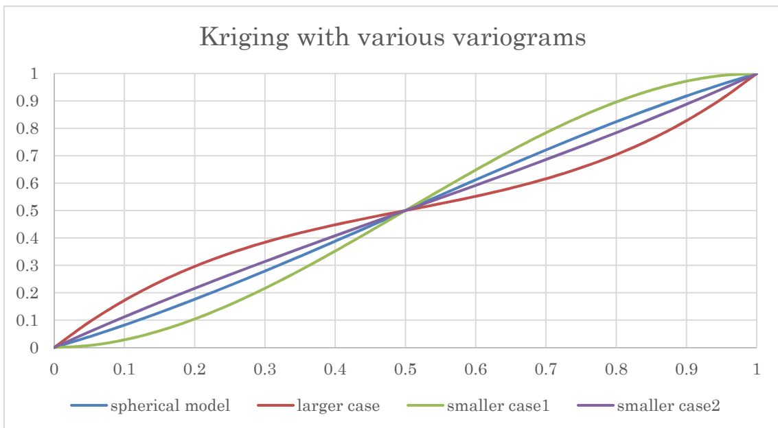
図5 : (29) ~ (32) 式で表されるバリオグラム関数を与えた場合のそれぞれの補間式をプロットしたもの。
