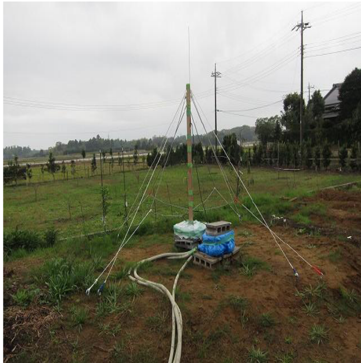
図 23 千葉県大網に設置したループアンテナの外観写真
