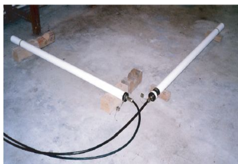
図 2.3 左：水平 2 成分サーチコイル磁力計，右：データ記録用コンピュータ [Sato,2004]
