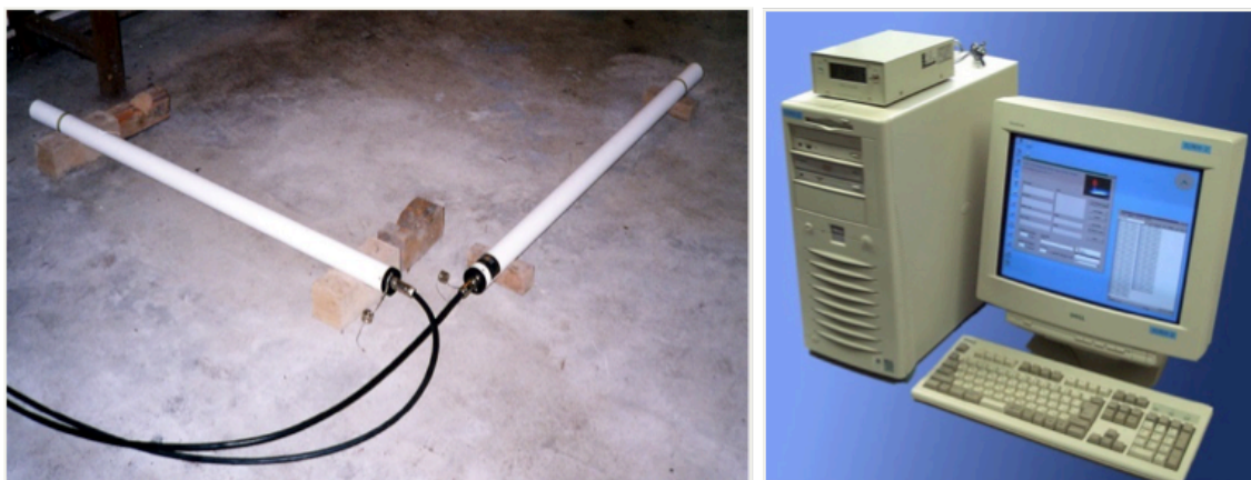
図 2.4 左：水平 2 成分サーチコイル磁力計. 右：データ記録用 PC. [Sato et al., 2013]
