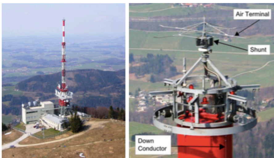
図 1.12 オーストリアのガイスバークタワーの外観と先端部のログスキーコイル [Diendorfer et al., (2009)].
