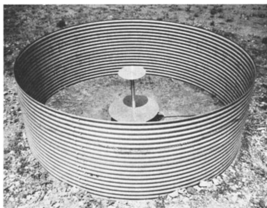
図 1.6 スローアンテナ (Krehbiel et al., 1979) (左) とその回路 (右)
