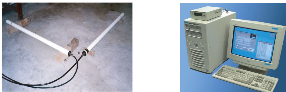
図 2.2 左：水平 2 成分サーチコイル磁力計，右：データ記録用コンピュータ [Sato, 2004]
