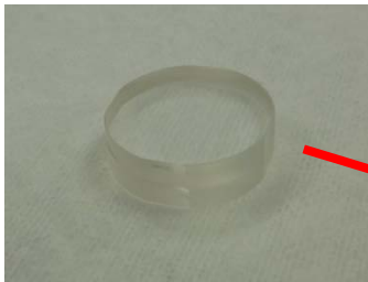
方解石ウォラストンプリズム (直径25mm, フィルターホイール#1へ)
