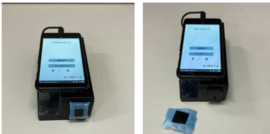
図 2.4 スマホ分光器のスリット部分に暗幕を取り付けた様子を示した写真
