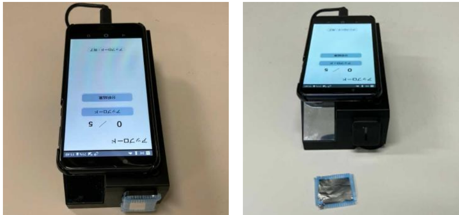
図 2.5 スマホ分光器のスリット部分にアルミホイルを取り付けた様子を示した写真
