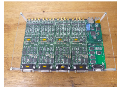
図 11.7 KWFC 用に開発された KAC(初号機) のアナログ処理部の外観 (2011 年東京大学加藤氏修士論文より引用)
