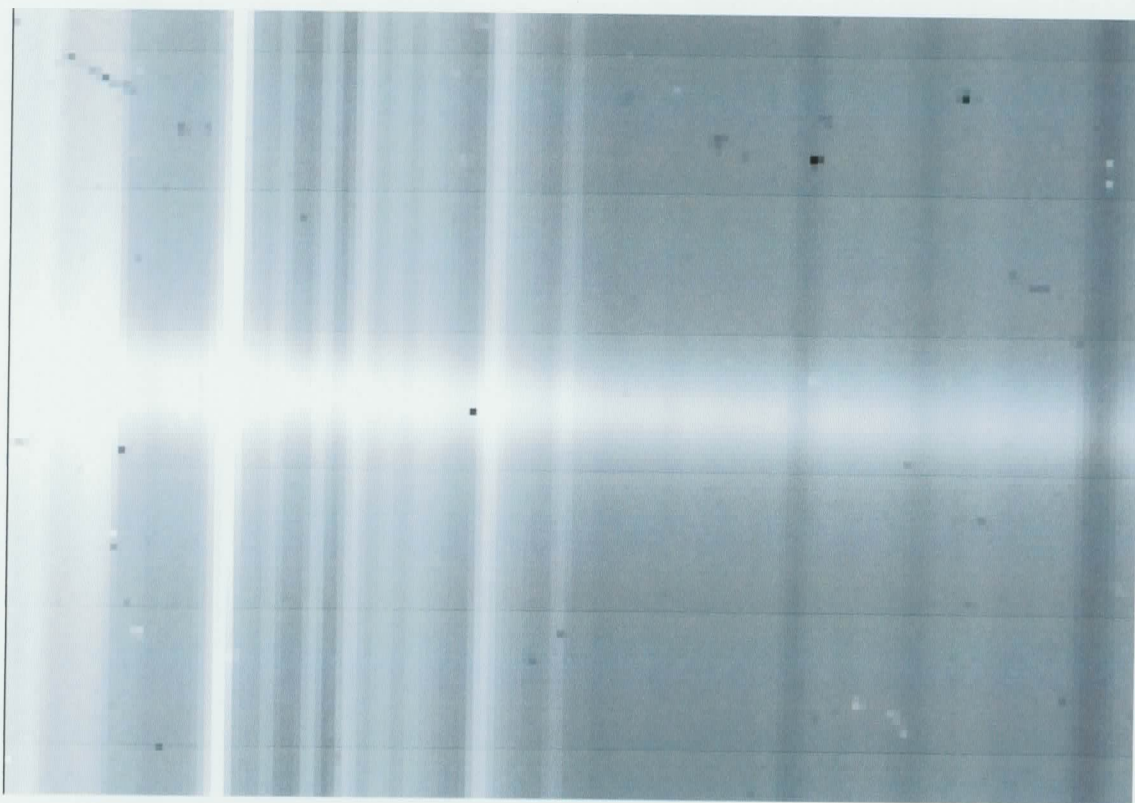
図 3.9 : garradd_d.fit のフラットフィールドニング後の画像 多少ではあるが感度ムラが修正されたため図 3.7 に比べると 画像の映りがよくなった部分があるのがわかる。いくつかあ る黒い点は感度が悪いピクセル部で BAD ピクセルと言われ るものである。
