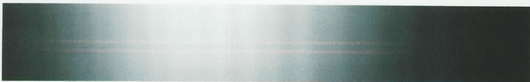
図 2.22 ピリカ望遠鏡のフラットランプによるフラットフィールドフレームと白熱灯によるフラットフィールドフレームの比較
