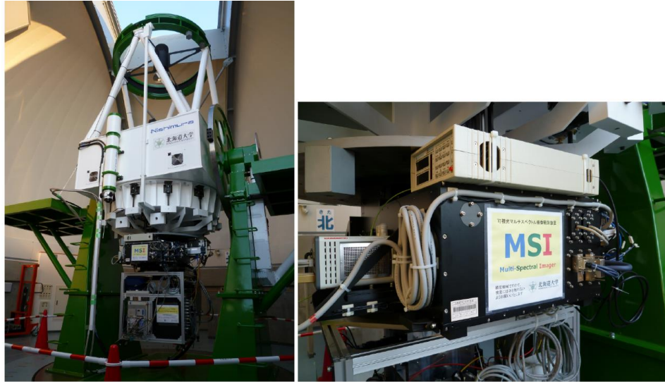
図 2.2 ピリカ望遠鏡 (左) 及び Multi-Spectral Imager (右)
