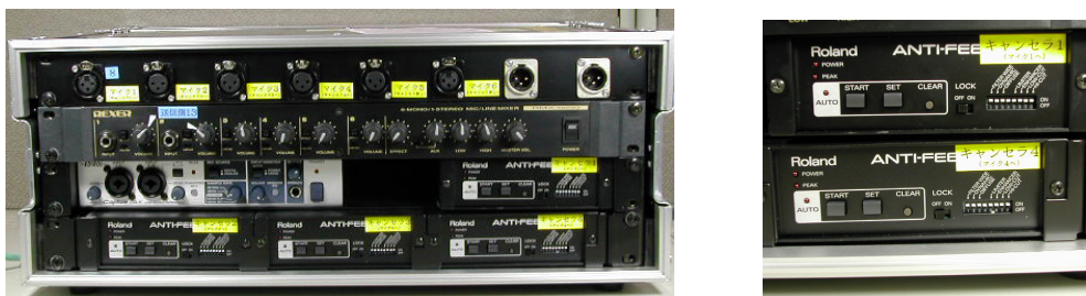
図 2.6: 音声システムラック (左). ミキサー (レクサ RMX-6000) は上から 2 段目. アンチフィードバック Roland AF-70 (右).
