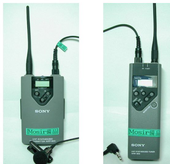
図 2.5: ワイヤレスマイク. 送信機 SONY WRT-805 (左), 受信機 SONY WRR-805 (右).
