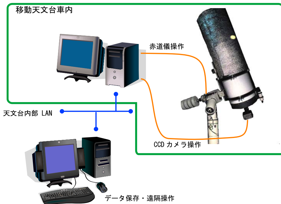
図 2.9: 移動天文台車内の望遠鏡 (口径 40cm シュミットカセグレン式) を使用した時の機器の接続 .
