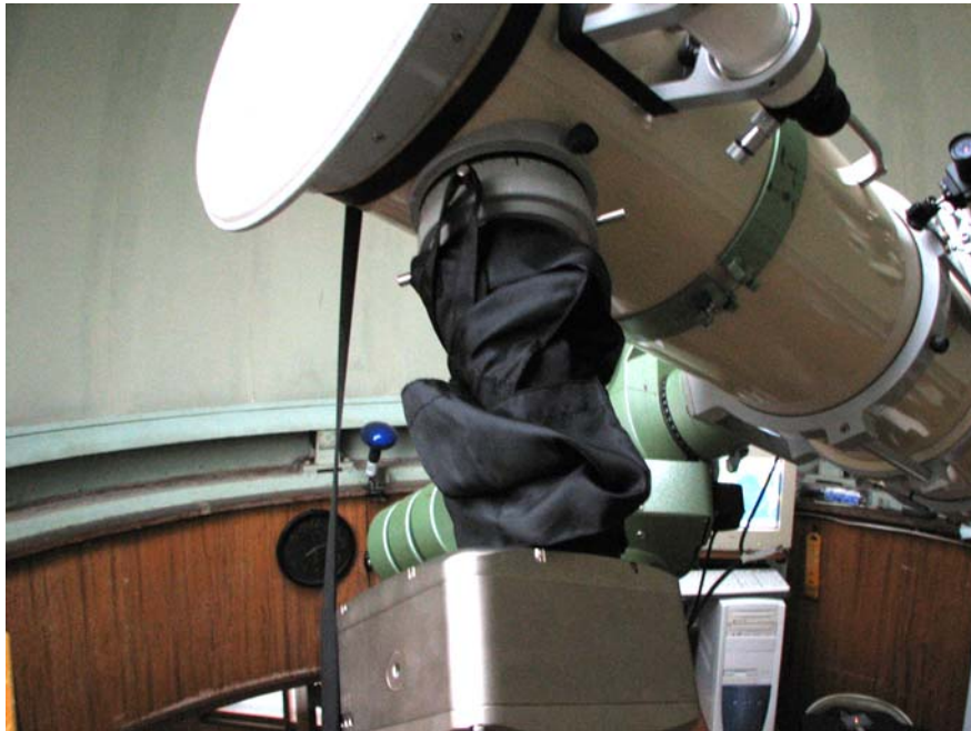
図 2.7: 望遠鏡と CCD カメラ．接続アダプターの周りに黒い布を巻くことで光の漏れを防ぐ．
